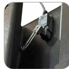
Height limit switch 上限位开关
